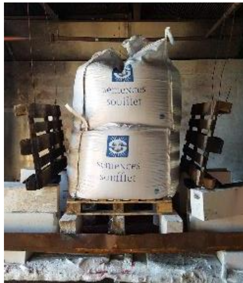
Figure 4-5 : Disposition de l'agression autour de la palette de big-bag
