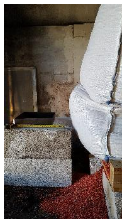
Figure 4-1 : Illustration de la position du bac d'heptane à côté du big-bag
